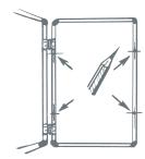
Durch die Öffnungen im Profil alle vier Löcher an der Wand markieren.
