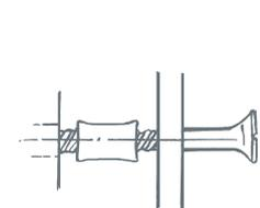
Schrauben durch die Öffnungen des EuroTwins und die Abstandhalter-Muffen in die Dübel leicht einschrauben.
