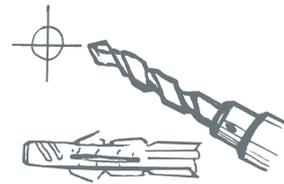
Die Wandtafel abnehmen, die Löcher bohren (Ø 8 mm) und die Dübel einstecken.
