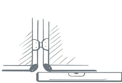
EuroTwin mit der Wasserwaage ausrichten.
