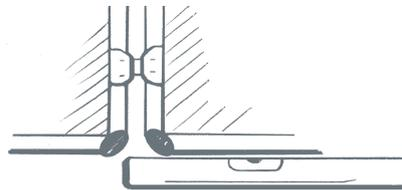
Mit der Wasserwaage kontrollieren und die Schrauben festdrehen.
