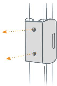
Vormontierte Schrauben lösen.
