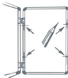
Durch die Öffnungen im Profil alle vier Löcher an der Wand markieren.
