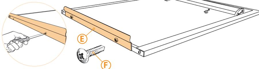
Tafel mit Schreiboberfläche nach oben auf einen Tisch legen. Stiftablage (E) passgenau vor Rahmenunterteil setzen und mit beiliegenden Schrauben (F) befestigen.
