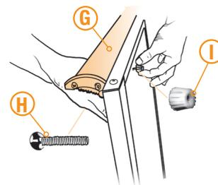
Papierhalterung (G) passgenau auf Tafeloberseite aufsetzen und Schrauben (H) durchstecken. Mit Kunststoffmutter (I) festsschrauben.
