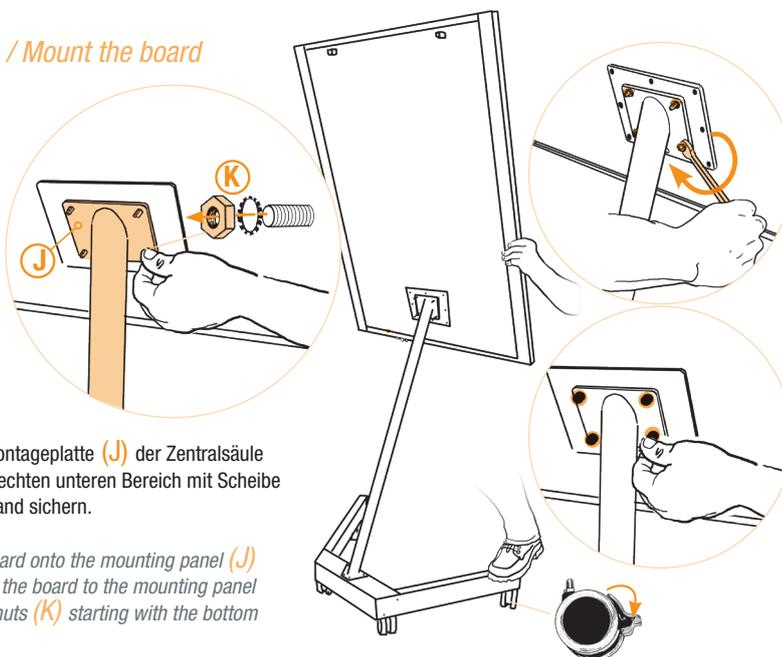
Tafel passgenau auf Montageplatte (J) der Zentralsäule aufstecken. Sofort im rechten unteren Bereich mit Scheibe und Mutter (K) per Hand sichern.
