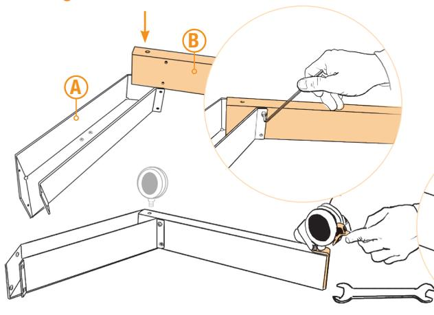
Hinteres Fußteil (A) mit der offenen Seite nach oben auf einen Tisch legen. Seitliches Fußteil (B) passgenau in Aussparung einlegen und mit 4 Schrauben befestigen. Blechwinkel (C) und Lenkrolle mit Bremse am Ende des Seitenteiles befestigen. Ungebremste Rolle gegenüber befestigen. Zweites Seitenteil auf gleiche Weise montieren.
