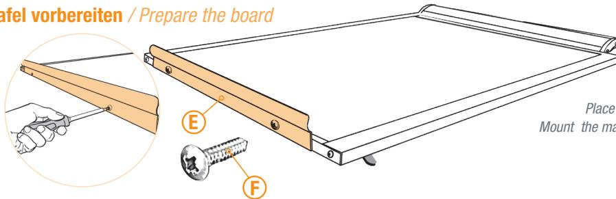
Tafel mit Schreiboberfläche nach oben auf einen Tisch legen. Stiftablage (E) passgenau vor Rahmenunterteil setzen und mit beiliegenden Schrauben (F) befestigen.
