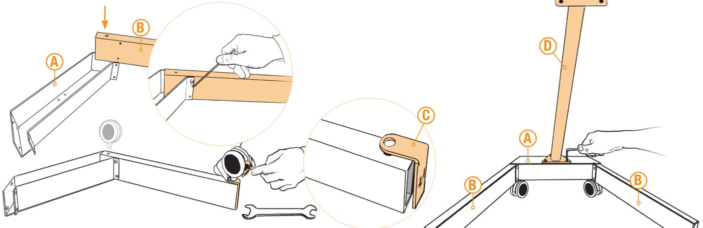
Hinteres Fußteil (A) mit der offenen Seite nach oben auf einen Tisch legen. Seitliches Fußteil (B) passgenau in Aussparung einlegen und mit 4 Schrauben befestigen. Blechwinkel (C) und Lenkrolle mit Bremse am Ende des Seitenteiles befestigen. Ungebremste Rolle gegenüber befestigen. Zweites Seitenteil auf gleiche Weise montieren.
