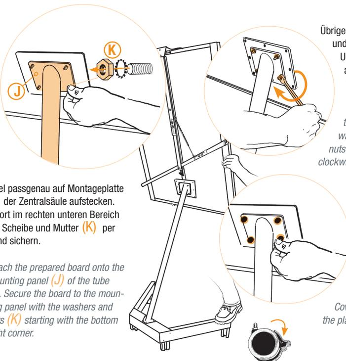
Tafel passgenau auf Montageplatte (J) der Zentralsäule aufstecken. Sofort im rechten unteren Bereich mit Scheibe und Mutter (K) per Hand sichern.
