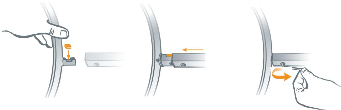
Vierkant-Druckstück in die Aussparung des Verbindungselementes am Fuß einsetzen...
