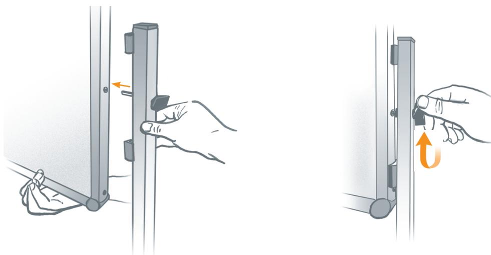
Die Flügelschraube des Beines in die richtige Schrauböffnung einführen.
