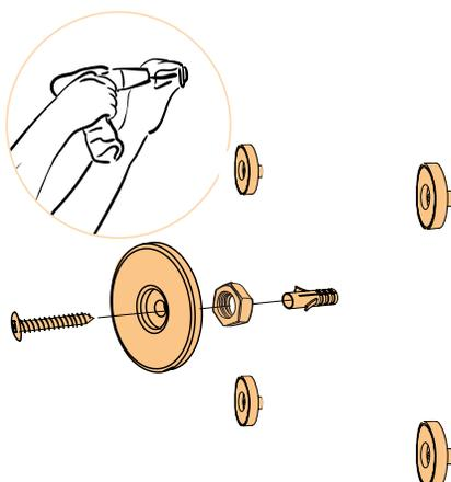
Magnethalterungen wie abgebildet montieren.
