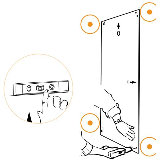
Vier Löcher durch die runden Markierungen vorbohren.
