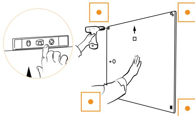
Schablone in der gewünschten Position an der Wand anlegen und mit einer Wasserwaage ausrichten.
