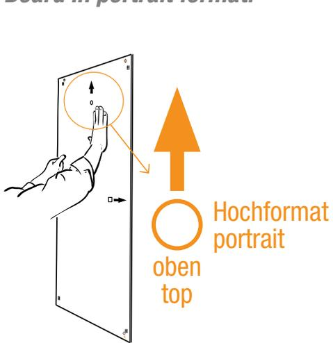
Schablone in der gewünschten Position an der Wand anlegen und mit einer Wasserwaage ausrichten.
