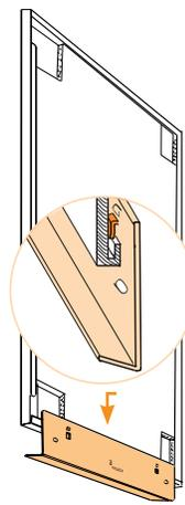
Stiftablage an der Rückseite der Tafel vormontieren.
