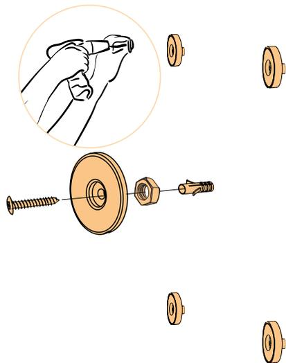
Magnethalterungen wie abgebildet montieren.
