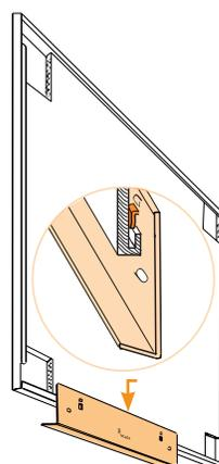
Stiftablage an der Rückseite der Tafel vormontieren.
